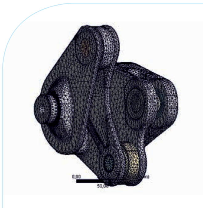
FEM – Simulation von Getriebeteilen
